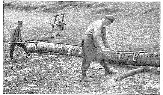
Abb. 2. Ansetzen von 2 Wendehaken beim Wenden an zwei entfernten Stellen des Stammes.
