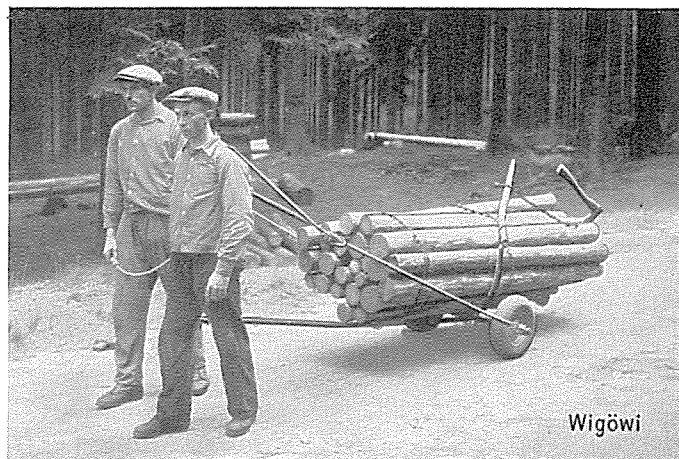
Ziehen von Schleif- und Brennholz mit der Wanne.
